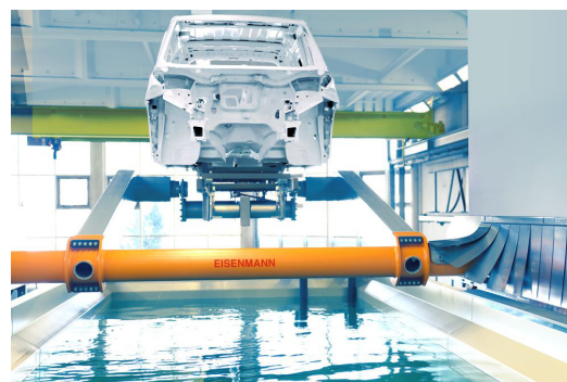
写真3 Eisenmann社の塗装ライン向け自動車前処理設備
