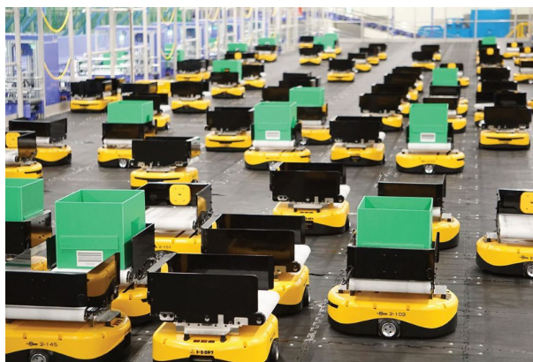
写真 ピッキング作業を効率化するAGV ※コープ自然派発表資料より抜粋
