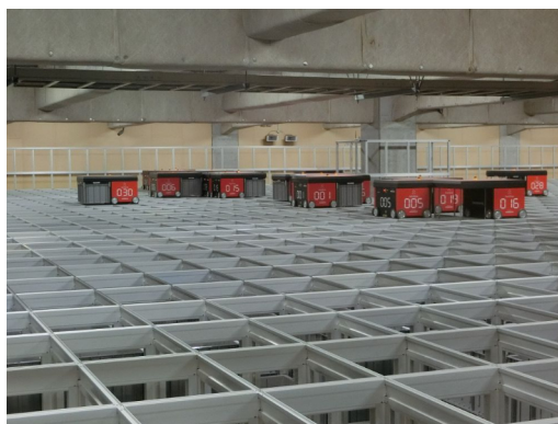
写真3 稼働する「AutoStore」。商品格納箱「Bin」を出荷指示に従ってロボットが保持し、ポートに搬送する。
