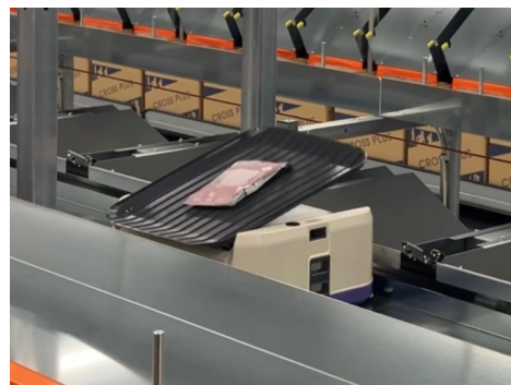
写真3 無人搬送ロボットのチルトトレイを傾けて商品を投入する
