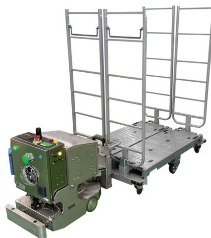
写真2 -25℃冷凍環境で安定稼働するAGV
