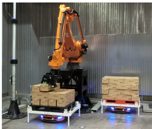
写真5 アーム式ロボット&パレット搬送AGV
