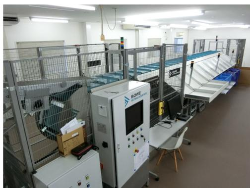
写真 本邦初公開のモジュール式高速仕分け機「MVS」
