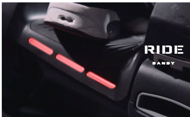
写真2 後進時にはバックライトが点灯。警報音も発する安全設計
