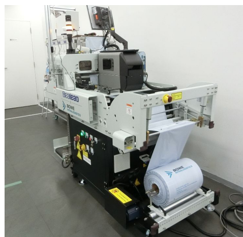
写真2 製袋加工されたロールフィルムを 使用するため生産性が高い
