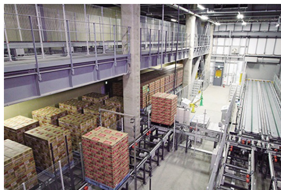
写真2 トラック荷役の自動化設備「ROROステーション」
