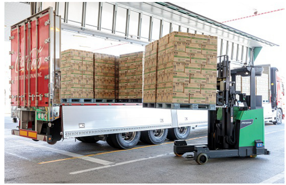
写真3 (株)豊田自動織機と開始した4本フォークタイプのトラック荷役対応自動運転フォークリフトの実証実験
