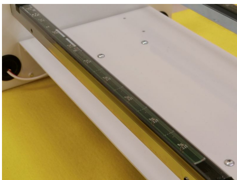
写真3 コンベヤに組み込まれているセンサー
