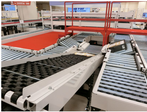
写真2 コンテナが斜めに傾き商品を取り出す
