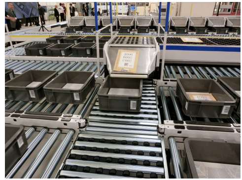
写真4 少ないシュート数で効率的な多方面仕分けを実現
