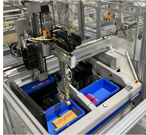
写真6 ピースピッキングに対応する「XY-ピッキングロボット」
