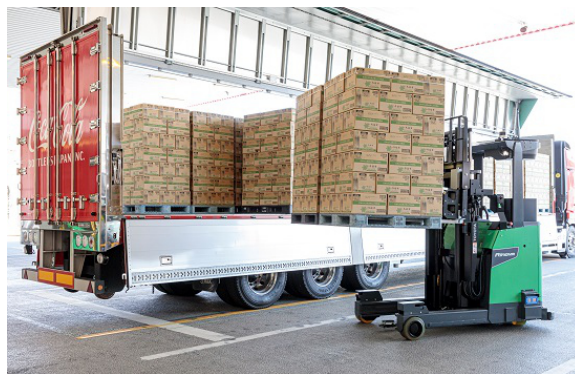
写真1 トラック荷役対応自動運転フォークリフト(4本フォークタイプ)
