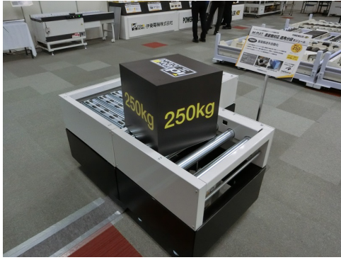
写真2 重量物対応直角分岐モジュール「M-RAT」
