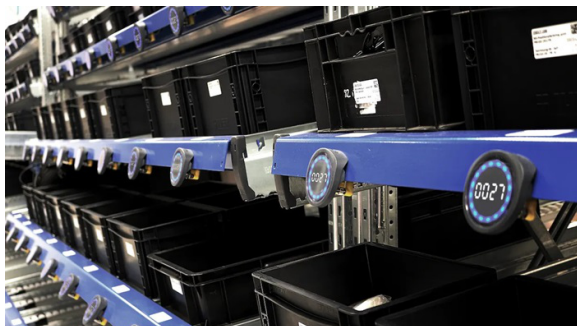
写真4 高い堅牢性と1億回以上のタッチができる「Smart CAPボタン」
