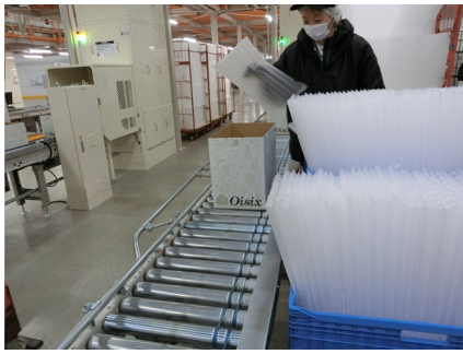
写真5 段ボールケースの中に緩衝材をセッティング
