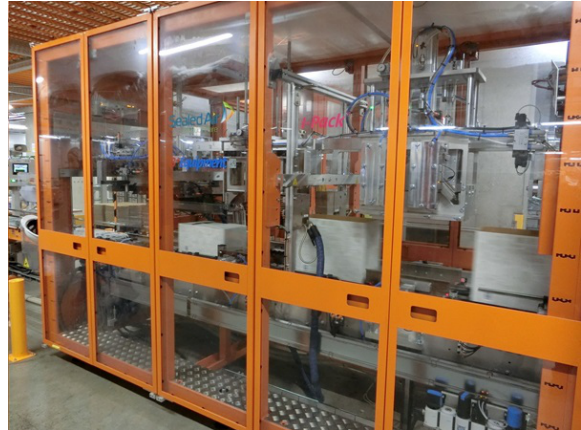
写真12 ケース高さ自動調整機能付き自動封緘システム「I-Pack」
