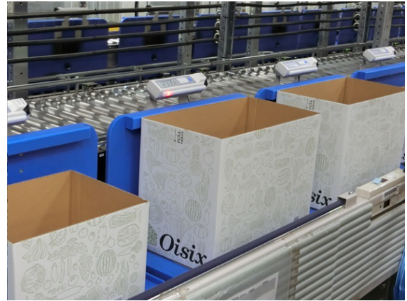
写真8 ピッキング商品を投入する段ボールケースを表示器のランプで示す
