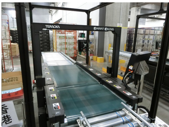
写真13 出荷荷物の寸法や重量を自動計測
