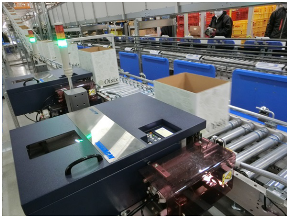
写真9 顧客識別バーコードラベルを自動貼付
