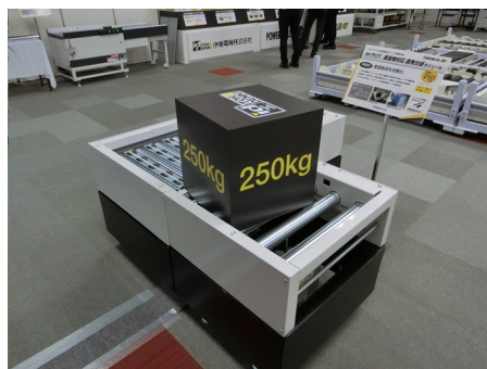
写真2 重量物対応直角分岐モジュール「M-RAT」
