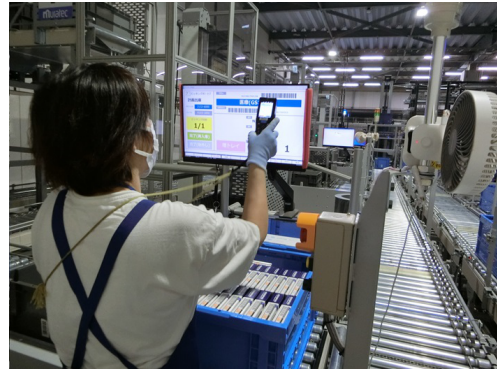
写真8 モニターを確認しながら製品をピックアップして搬送用コンテナに移し替える
