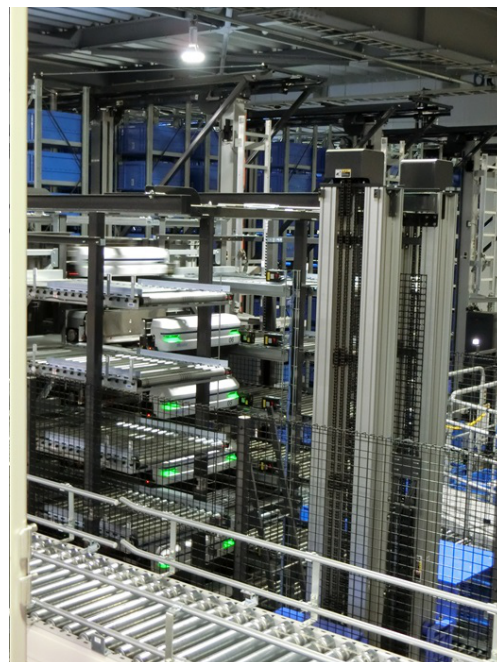
写真9 搬送用コンテナを受け入れて出荷順に並べ替えるユニシャトル
