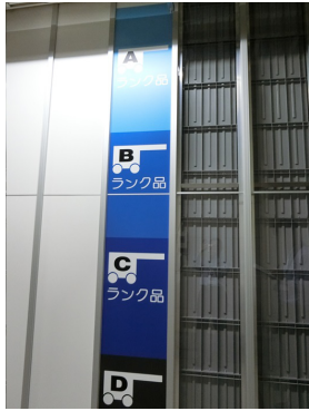
写真6 より出庫頻度の高い「Bin」がグリッド上段に積み上がる仕組み
