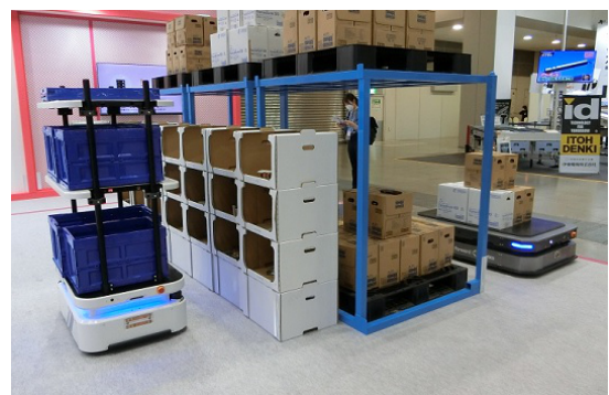
写真3 ケースピッキングをアシストできる「Flexシリーズ」(左)と「Maxシリーズ」(右)
