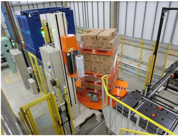
写真8 出庫状態が整った後は荷崩れ防止のためにパレットストレッチ包装
