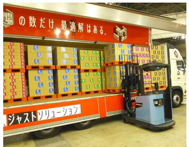
「トラック荷役対応自動運転フォークリフト」の稼働実演
