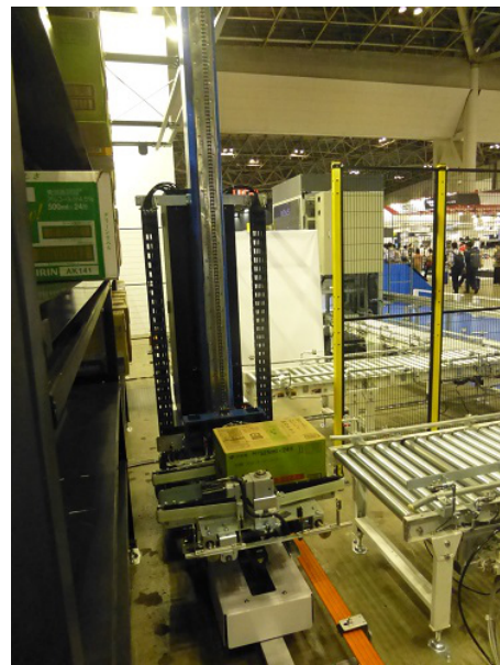
ケース自動倉庫「RIO」+6輪カート用パレタイズ装置「カートケースローダー」+牽引型AGV「TOW-S03」で荷役自動化を実演
