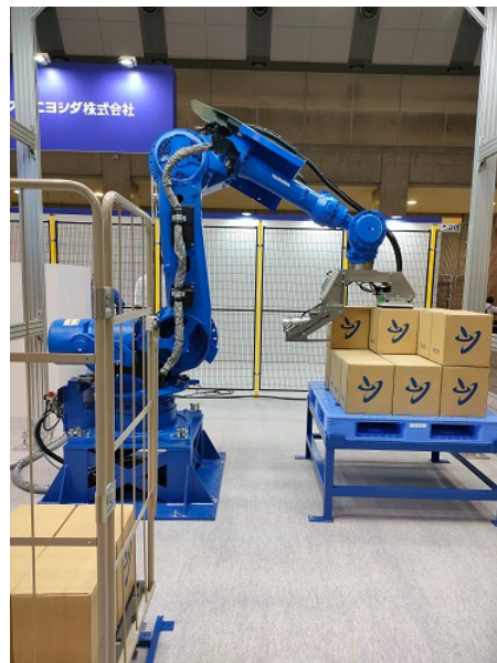
「ORS」によるパレットからカゴ車への段ボール荷物の移載の実演
