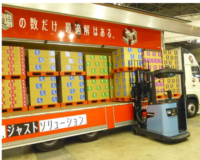
写真3 トラック荷役対応自動運転フォークリフト
