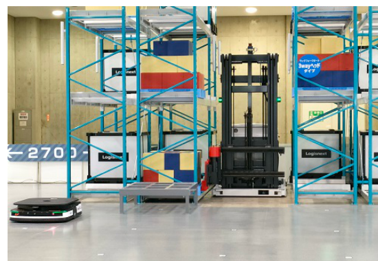
レーザー誘導式無人フォークリフト 「PLATTER AUTO」
