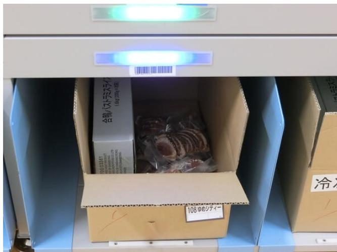
写真7 仕分け完了でランプが点灯するため、出荷作業の効率化が可能
