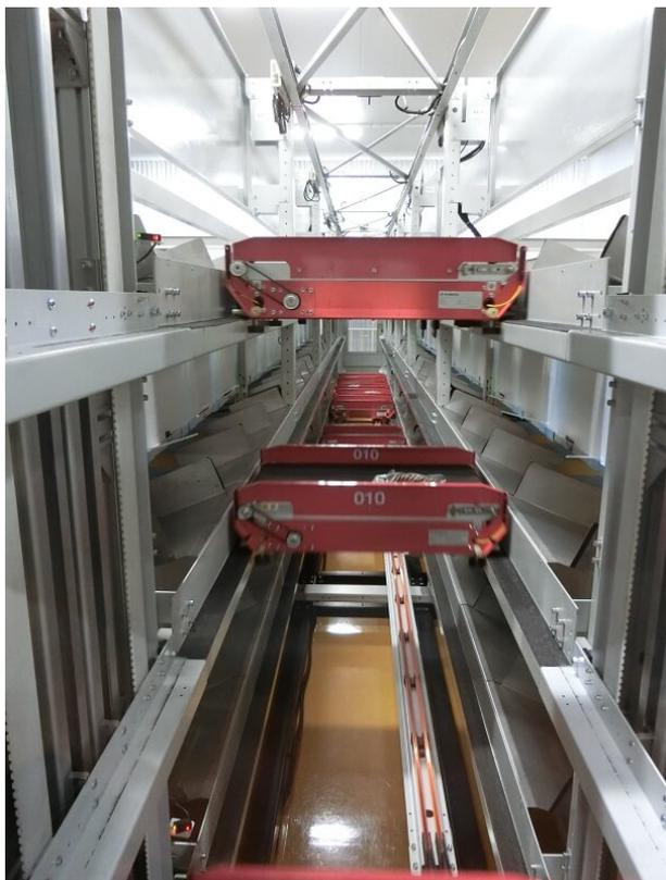
写真6 商品を載せた搬送ロボットが誤りなく高速で所定の間口に移動
