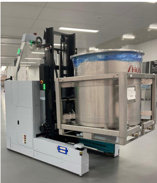
写真2 AGVでバルク搬送を自動化
