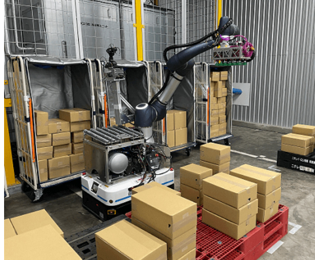
写真5 カゴ車に自動で荷物を積み付ける遠隔ロボット
