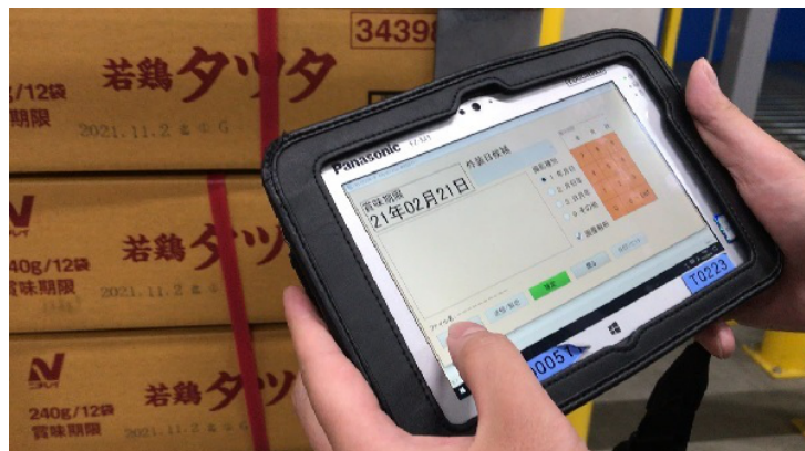
写真4 タブレットで段ボールに印字された賞味期限を読み取りデータ化
