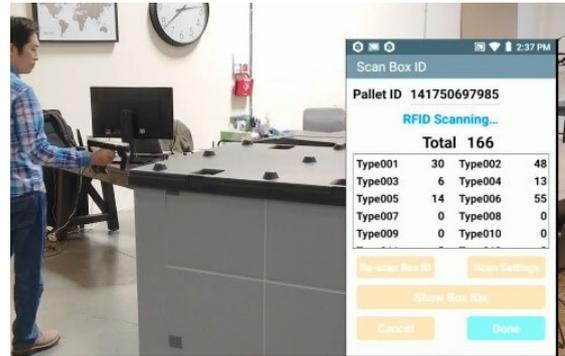
写真3 読み取ったRFIDの数がリーダーのモニタにリアルタイムで表示される
