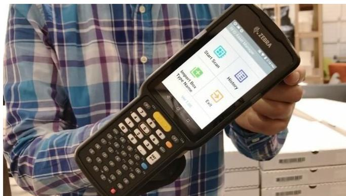
写真1 RFIDリーダー機能を搭載したハンディターミナル
