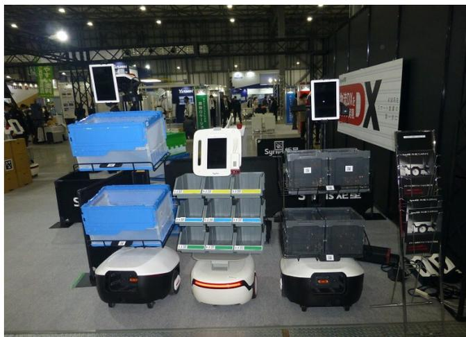
自律走行型ピッキング補助ロボット「FlexComet」と「FlexSwift」
