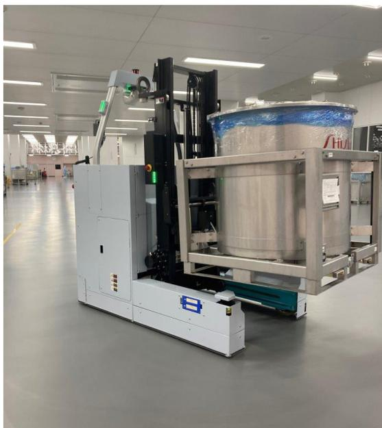
写真5 AGVでバルク搬送を自動化
