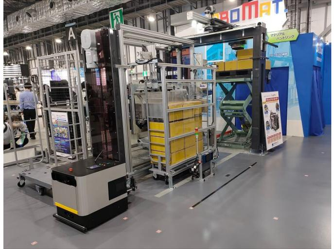
6輪カート自動積み付け装置「トランシップ・カートローダー」と6輪カートを牽引するAGV「TOW-SO3」
