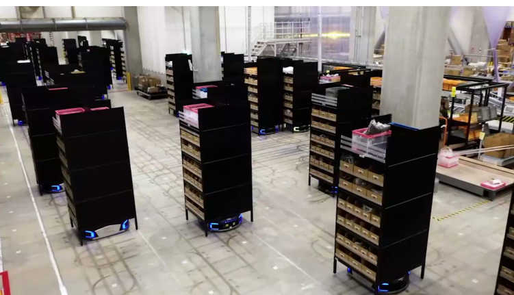
写真7 ASKUL三芳センターで新たに導入された 自動棚搬送ロボット
