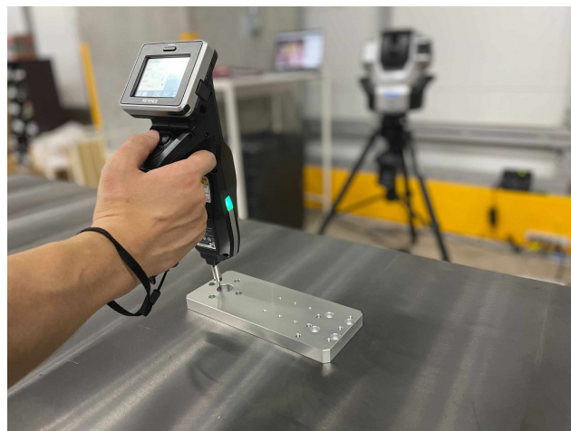
写真5 高精度の部品は3D測定装置で寸法を測定
